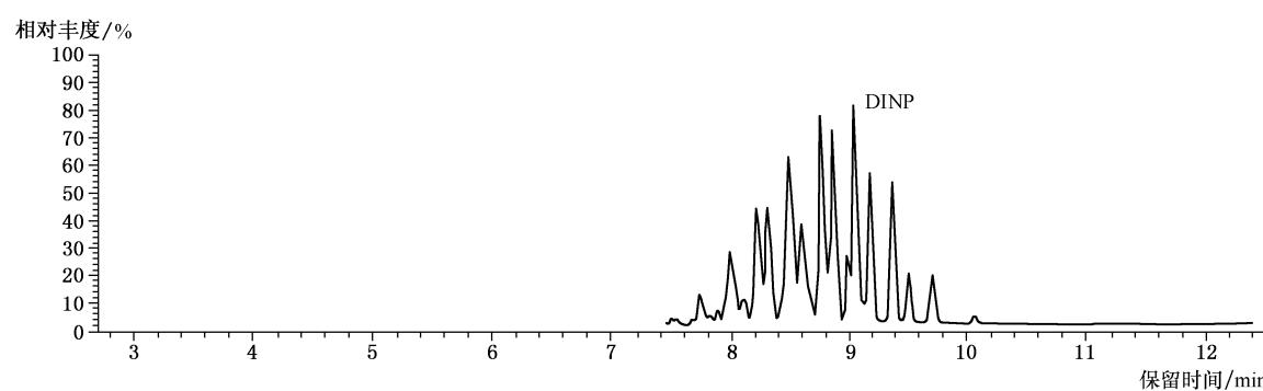
图 C.4 DINP 标准物的 GC-MS 选择离子( $m/Z=293$ )色谱图
