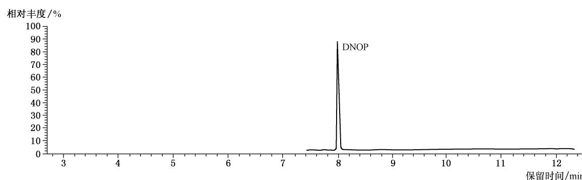
图 C.3 DNOP 标准物的 GC-MS 选择离子( $m/Z=279$ )色谱图
